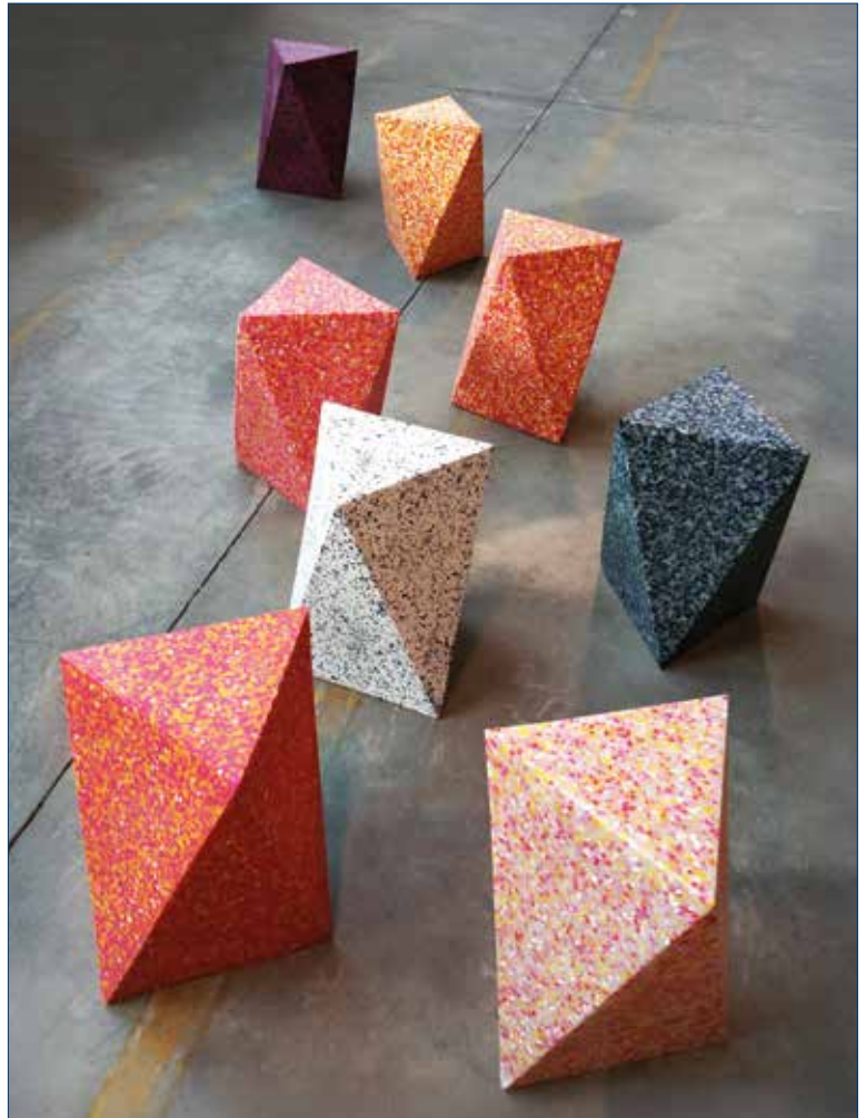
Doordat de oorspronkelijke pigmenten niet mengen, resulteert Ecopixel in een kenmerkend gepixeld uiterlijk.
